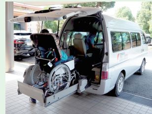
ワゴン車に乗車する様子。この時点で車椅子はリフトに固定されています。
