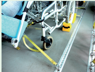
バス内の固定の様子。床面にレールが敷いてあり、任意の場所で固定が可能です。
