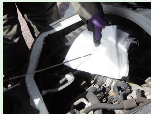
日常点検の様子。オイルと水。タイヤの状態、ライトのテストなどを点検し、日報に記入します。
