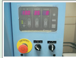
乾燥機の設定パネル 左下の赤いボタンは非常停止ボタン
